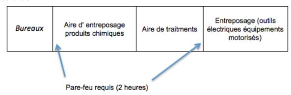
Sous ce scénario, les murs extérieurs doivent être à l'épreuve du feu ou fournir un minimum de résistance au feu d'une heure. Une séparation affichant une résistance au feu de deux heures est requise entre les bureaux et l'aire d'entreposage des produits chimiques.
