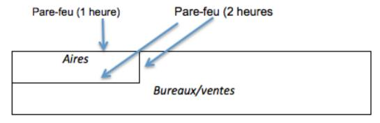
Sous ce scénario, les murs extérieurs doivent être à l'épreuve du feu ou fournir un minimum de résistance au feu d'une heure. Une séparation affichant une résistance au feu de deux heures est requise entre les bureaux et les aires d'entreposage des produits chimiques et de traitements de semences.
